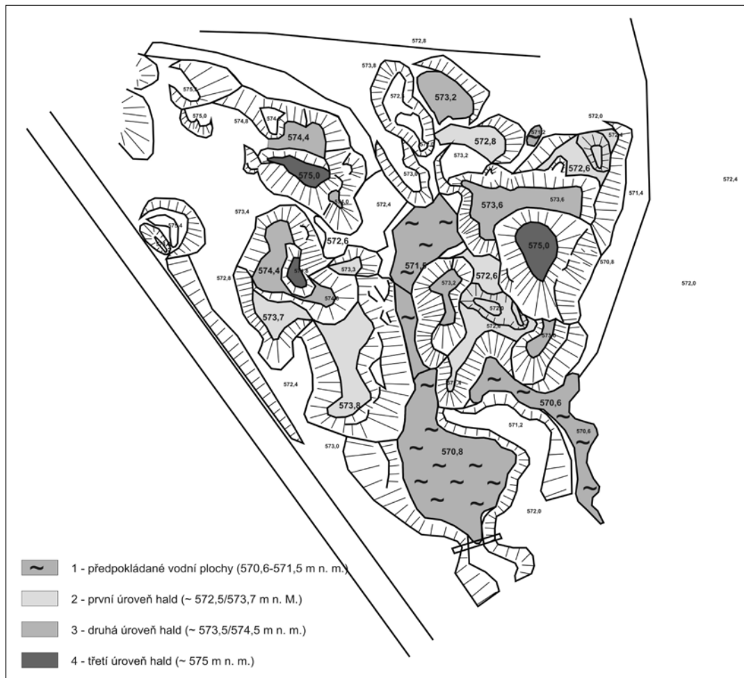
• Obr. 33 – Interpretace reliéfu části rýžoviště zaměřeného metodou pozemního laserového skenování. 1 - předpokládané vodní plochy a kanály, 2 – původní terén, 3 – první vrstva hald, 4 – nejmladší halda. Autor: J. Večeřa. Podle Zezula, M. a kol. 2021.
